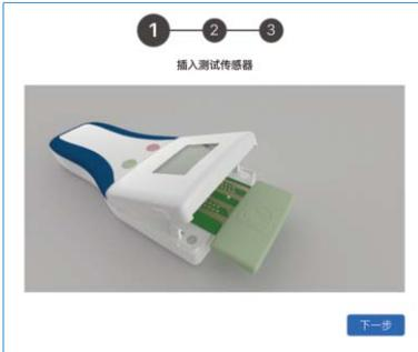
图20：传感器测试第1步，将测试传感器插入手持设备
