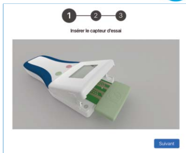
Figure 20: Première étape du test du capteur, insérer le capteur d'essai dans le dispositif
