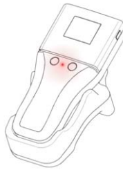
Figure 4: Une LED fixe indique que la recharge des piles est en cours. (Ce n'est pas une note d'avertissement !)
