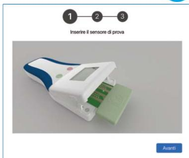
Figura 20: Primo passaggio: inserire il sensore di prova nel dispositivo portatile
